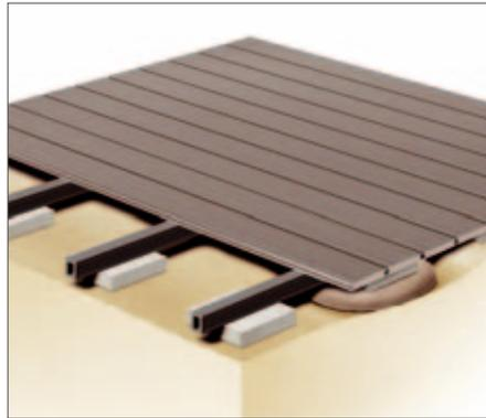
Zu Wänden oder festen Bauteilen Abstand von 10 mm einhalten. Verlegeabstand der Balken max. 50 cm. Werden die Terrassendielen anschließend diagonal verlegt, ist der Balkenabstand entsprechend zu verringern.
