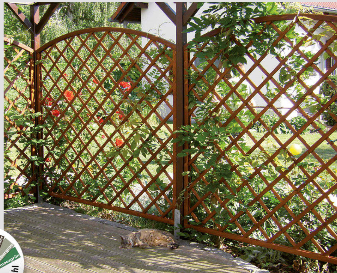
Rankgitter Napoli Rahmenteile 4,3 x 4,3 cm gehobelt, Ecken gezapft, Streben 1,2 x 3,0 cm, gehobelt und abgerundet, Maschenweite 12 cm, kesseldruckimprägniert
