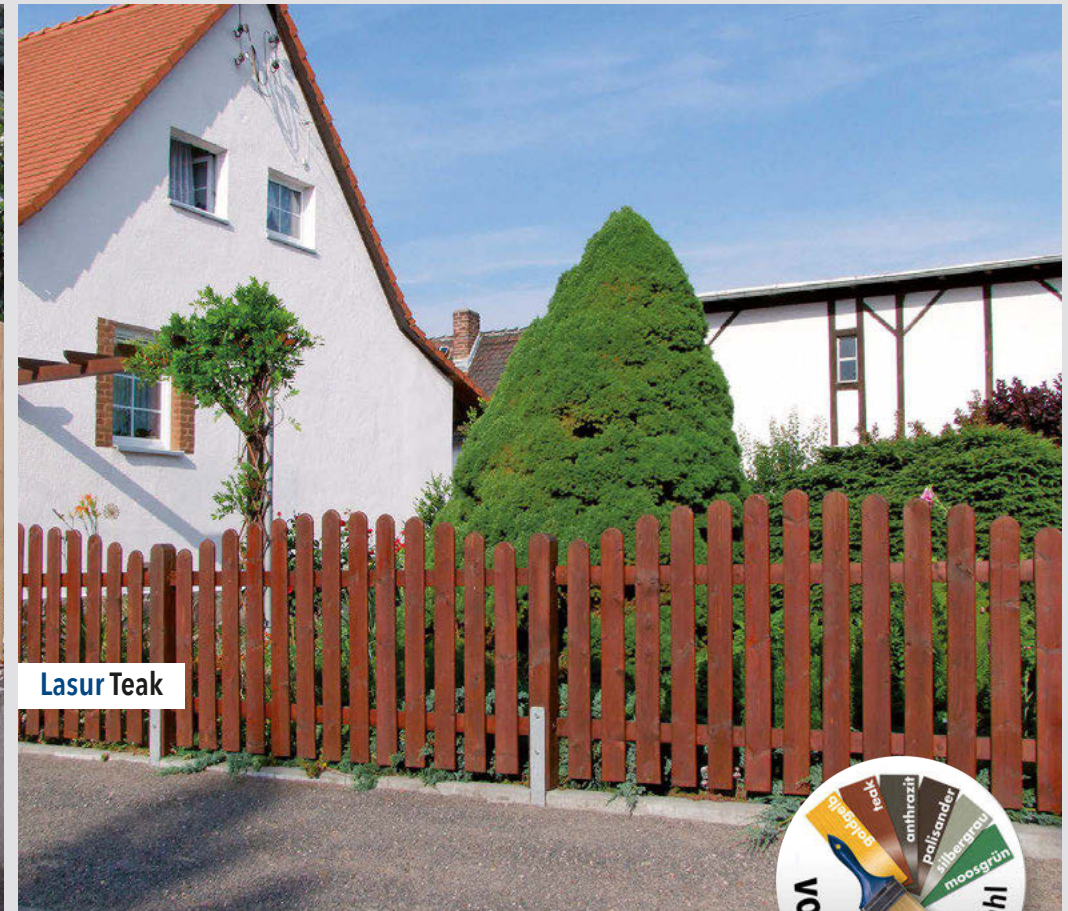
Staketenzaun Föhr geschwungen aus Fichte/Kiefer Bretter 2,0 x 9,5 cm gehobelt, verzinkt genagelt, Kanten gefast, Kopf gerundet, kesseldruckimprägniert 13 Staketen pro 180'er Feld
